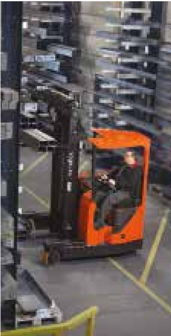
BT Reflex F-sarjan asetinlaitteen haarukoiden leveyden säätö helpottaa eripituisten kuormien turvallisen käsittelyn
