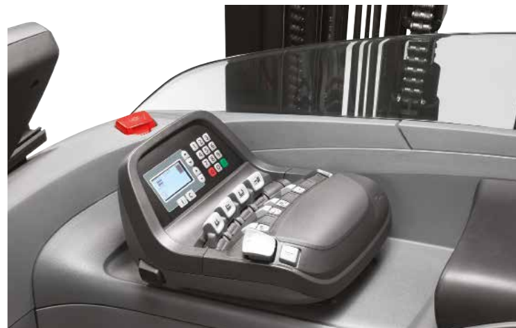
Säädettävät minivivut tarkkaan työskentelyyn
