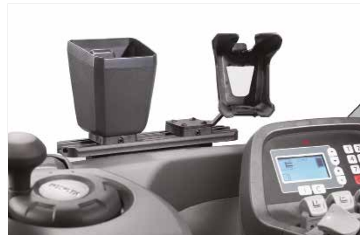
E-bar -kiinnityskiskoon voidaan asentaa monenlaisia lisätarvikkeita
