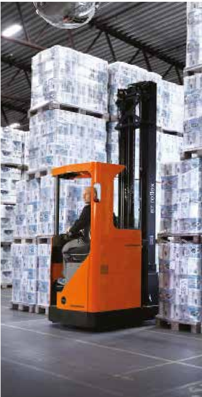
Trukin rakenne parantaa näkyvyyttä myös kuljettajan taakse
