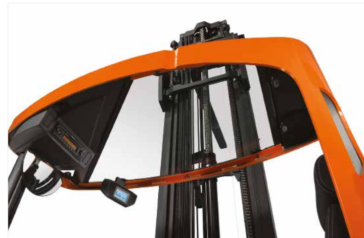
Työntömastotrukin läpinäkyvä katto luo esteettömän näkyvyyden ylöspäin
