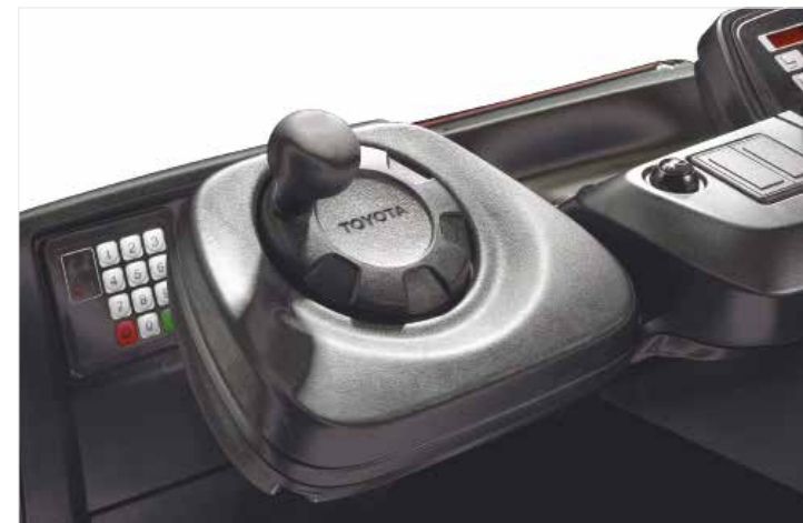
BT Reflex N-sarjan malleissa on 360° ohjaus hyvällä ohjaustuntumalla
