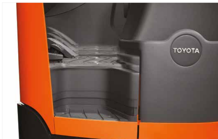
Kuljettajantilan lattian korkeutta voidaan säätää manuaalisesti tai sähkökäyttöisesti
